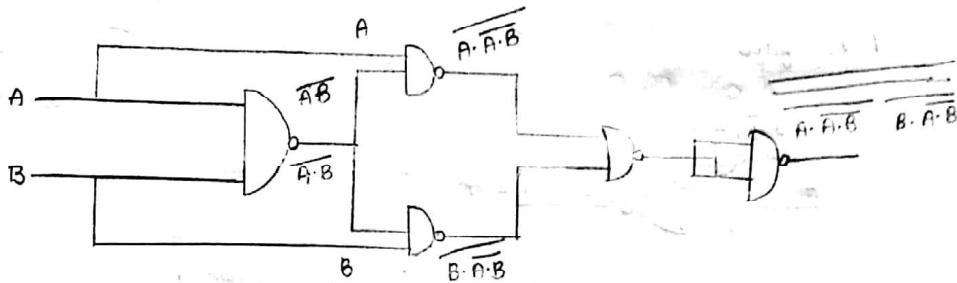
$$Y = \overline{A \cdot \overline{A} \cdot B} \cdot \overline{B \cdot \overline{A} \cdot B}$$
